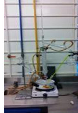
Figura 1. Mecanismo de columna empacada (25 cm), semi-batch.
