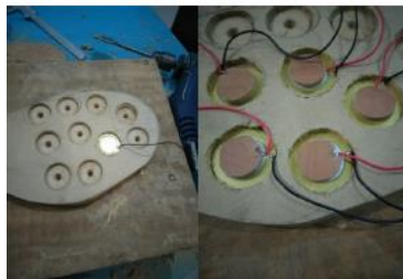
Figura 17 Base del prototipo con los piezoeléctricos colocados.
