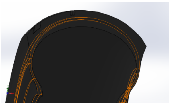
Figura 6. Vista seccionada de la carcasa del neumático
