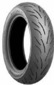
Figura 2. Neumático 120/70 R12 Fuente: www.michelin.es
