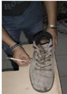
Figura 10. Trazo de la circunferencia de la bota en una superficie de madera
