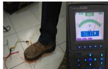
Figura 19. Prototipo en prueba conectado en serio mostrando valor de 32.17 volts
