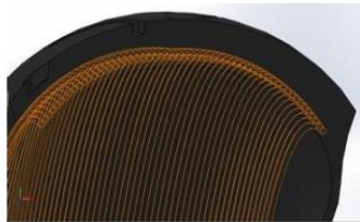
Figura 5. Vista de la lona de cima del neumático.
