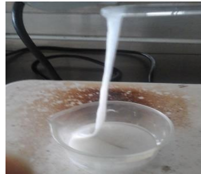
Figura 1. Disolución del poliestireno en acetona.
