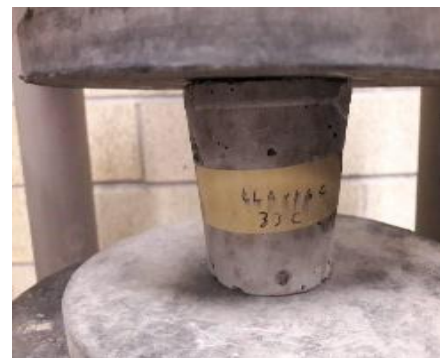
Figura 5. Prueba de compresión de la muestra
