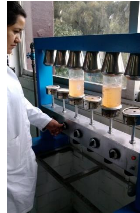
Figura 1. Colocar el vaso Berzelius en la parrilla del Digester Kennedy.
