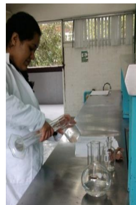
Figura 3. Agregar Hidróxido de Sodio para la digestión alcalina.
