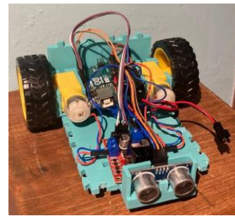
Figura 13. Diseño ensamble final robot evasor de obstáculos [creación propia]
