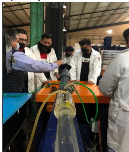
Figura 5. Banco de pruebas con el tubo de Venturi. Fuente: Propia, J. S. Villarreal, J. J. Martínez y I. Arjona.
