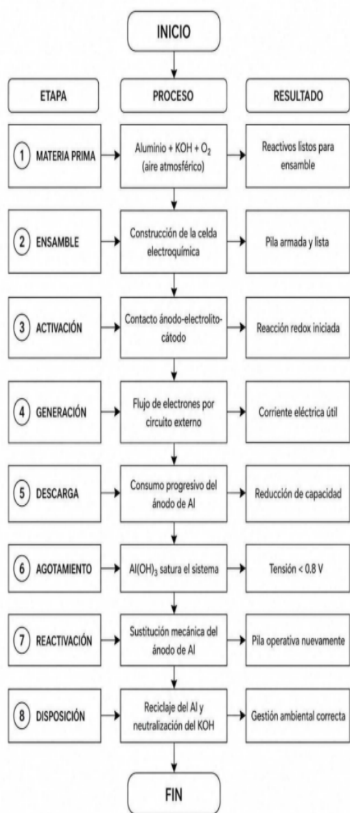
Figura 2. Desarrollo del proceso para la fabricación de la pila de aluminio.
