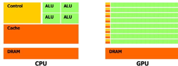
Figura 3. Distribución de transistores en GPU y CPU: la GPU asigna la mayor parte al procesamiento aritmético paralelo, mientras la CPU los destina a caché y unidades de control de flujo. Fuente: NVIDIA Corporation (2007).
