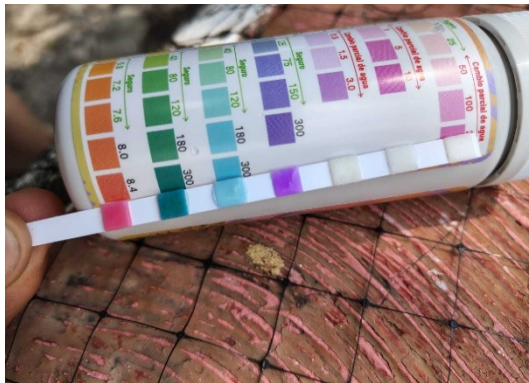
Figura 1. Ejemplo de tira reactiva comparada con la escala de colores impresa (elaboración propia).
